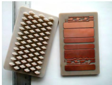
Fig. 8. Structure AlN en nid d'abeille et face arrière cuivrée. (Photo AnCeram)
